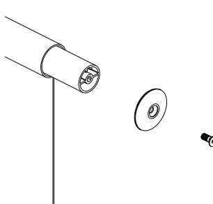
rimuovere il cappuccio di chiusura per il montaggio della bandiera
