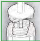
B il sistema frenante: integrato nel meccanismo, il freno regola la sua azione frenante in base alla velocità di rotazione dell'avvolginastro. il nastro viene riavolto con la stessa velocità dall'inizio alla fine. si evitano così ferite alle mani e alle dita a causa di un riavvolgimento incontrollato e troppo veloce.
