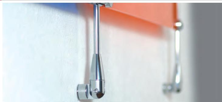
**IT** connettore snodabile di astine. utilizzabile per il fissaggio a parete e come connettore per 2 astine. il giunto, ruotabile di 180°, permette di montare le astine non solo ad angolo retto ma anche in altre direzioni. agganciare le due parti di arte alle astine, mettere la brugola all'estremità delle astine e avvitare per collegarle. spessore dell'astina: Ø6mm.
