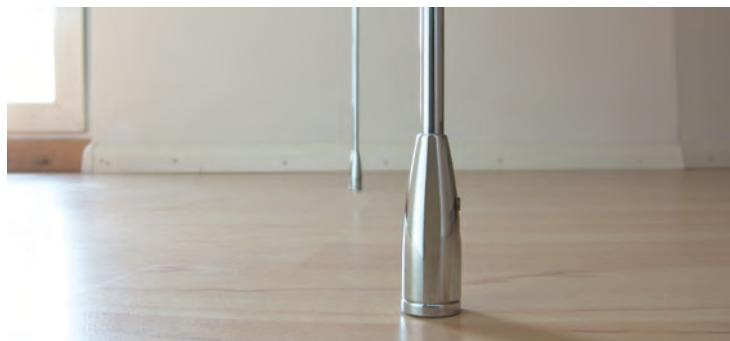
**IT** base di appoggio regolabile per astine. inserire l'astina nella base e fissarla con la brugola laterale. grazie alla regolabilità data dall'avvitamento si può scegliere la lunghezza desiderata, si possono eliminare piccole irregolarità del pavimento e l'astina viene tenuta perfettamente in tensione. spess. astina: Ø6mm.
