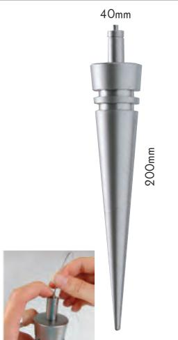
**IT** contrappeso per sistemi su cavi con autobloccaggio. mantiene i cavi in tensione in modo elegante e senza montaggi a terra o a parete. inserire il cavo nel sistema auto-bloccante, che lo trattiene automaticamente. peso: 750g. spessore del cavo: max. Ø1,8mm.
