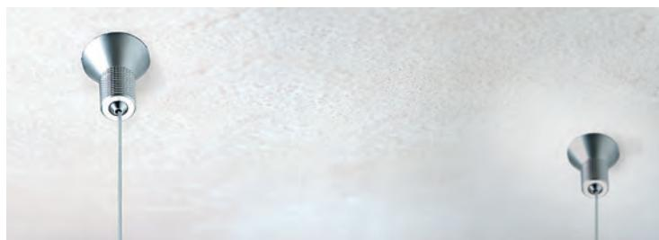
**IT** tirante per cavi, sistema in tensione a brugola. fissaggio a soffitto universale per cavi di acciaio, nylon o per catenelle. montare il tirante a soffitto, inserire il cavo nel morsetto e fissarlo con le brugole. regolare la tensione avvitando la parte zigrinata. spessore del cavo: max. Ø1,8mm.
