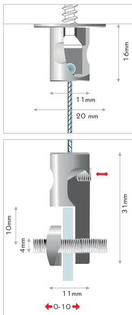
**IT** per la sospensione a soffitto: un supporto su cavi per il soffitto, un supporto per pannello e 2m di cavo in acciaio con terminale in pressofusione. materiale: alluminio anodizzato color argento.
