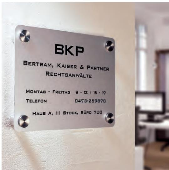
**IT** sistema di fissaggio in acciaio con chiusura laterale di sicurezza per piccoli formati. fissare il distanziale alla parete, posizionare il pannello, inserire la testina nel foro e attraverso il pannello e completare il fissaggio tramite la brugola laterale di sicurezza, che impedisce che la targa possa venir manomessa o smontata. materiale: acciaio inox AISI304, testina con sfaccettature.
