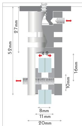
**IT** morsetto variabile a bandiera in acciaio per parete o soffitto. per montaggi di pannelli a bandiera o direttamente a soffitto. il fissaggio del pannello avviene tramite le brugole. fissaggio: morsetto variabile a bandiera con sistema a brugola. materiale: acciaio inox AISI303.
