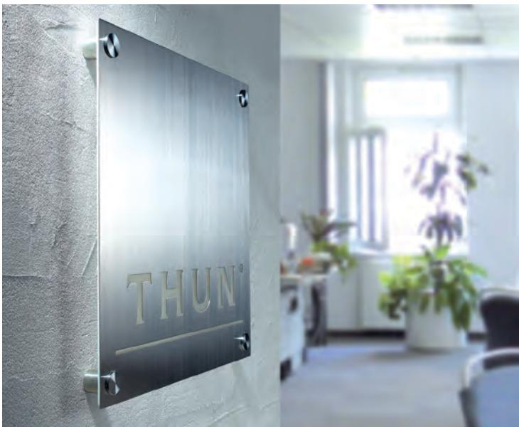
**IT** sistema di fissaggio in acciaio con chiusura laterale di sicurezza per piccoli formati. fissare il distanziale alla parete, posizionare il pannello, inserire la testina nel foro e attraverso il pannello e completare il fissaggio tramite la brugola laterale di sicurezza, che impedisce che la targa possa venir manomessa o smontata. materiale: acciaio inox AISI304, testina con sfaccettature
