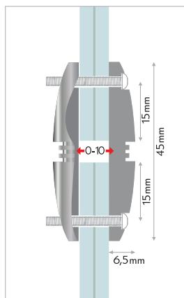
**IT** connettore variabile in acciaio per pannelli. morsetto in acciaio inox per la connessione verticale di pannelli. il fissaggio avviene tramite le brugole. fissaggio: connettore variabile per pannelli con diversi spessori. materiale: acciaio inox AISI303.
