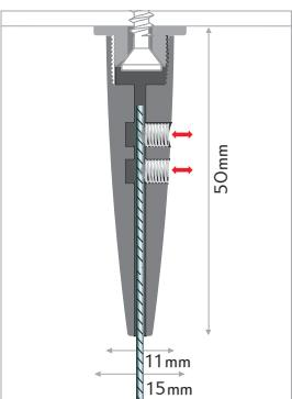
**IT** tirante per cavi con sistema a brugola. fissaggio a soffitto universale per cavi di acciaio o di nylon o per catenelle. montare il tirante a soffitto, inserire il cavo nel morsetto e fissarlo con le brugole. fissaggio: tirante per cavi, sistema a brugola. materiale: ottone cromato. spessore del cavo: max. Ø1,8mm.
