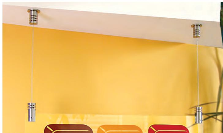
**IT** tirante in acciaio per cavi con sistema a brugola. fissaggio a soffitto universale, in acciaio inox, per cavi di acciaio o di nylon o per catenelle. montare il tirante a soffitto, inserire il cavo nel morsetto e fissarlo con le brugole. fissaggio: tirante per cavi, sistema a brugola. materiale: acciaio AISI303, testina con sfaccettature. distanza dal soffitto: 35mm. spessore del cavo: max. Ø1,8mm.
