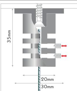
**IT** tirante in acciaio per cavi con sistema a brugola. fissaggio a soffitto universale, in acciaio inox, per cavi di acciaio o di nylon o per catenelle. montare il tirante a soffitto, inserire il cavo nel morsetto e fissarlo con le brugole. materiale: acciaio AISI303, testina con sfaccettature. spessore del cavo: max. Ø1,8mm.
