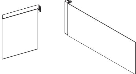
**IT** per il fissaggio perpendicolare di pannelli singoli, clamper support si fissa facilmente inserendo la lastra nei fori predisposti. se usato in combinazione con pannelli debitamente piegati e con clamper, potete creare anche della segnaletica a bandiera o a soffitto. materiale: alluminio.
