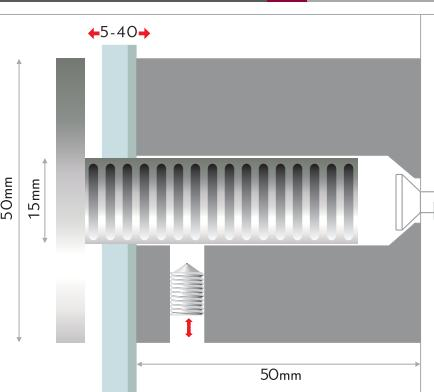
**IT** sistema di fissaggio in acciaio con chiusura laterale di sicurezza per lastre spesse e pesanti. materiale: acciaio inox AISI304, testina con sfaccettature.
