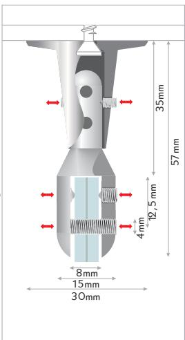
**IT** morsetto a bandiera per parete o soffitto. per montaggi di pannelli a bandiera o direttamente a soffitto. il fissaggio del pannello avviene tramite le brugole. fissaggio: morsetto a bandiera con sistema a brugola. materiale: ottone con cromatura.
