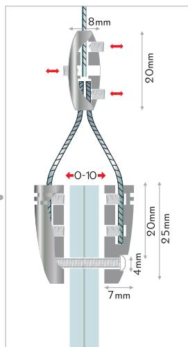
**IT** morsetto variabile in acciaio per pannelli con cavi. morsetto per cavi di acciaio o di nylon o per catenelle. il fissaggio del pannello e del cavo avviene tramite le brugole. fissaggio: morsetto per pannelli, variabile, per diversi spessori, sistema a brugola. materiale: acciaio AISI303. spessore del pannello: max. 10mm. grazie all'utilizzo di brugole più lunghe è possibile fissare anche spessori maggiori. spessore del cavo: max. Ø1,8mm.
