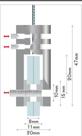
**IT** morsetto in acciaio per pannelli con cavi. morsetto per cavi di acciaio o di nylon o per catenelle. il fissaggio del pannello e del cavo avviene tramite le brugole. anellini di protezione inclusi. fissaggio: morsetto per pannelli, sistema a brugola. materiale: acciaio AISI303, testina con sfaccettature. spessore del pannello: max. 8mm o 11mm senza anellini. spessore del cavo: max. Ø1,8mm.
