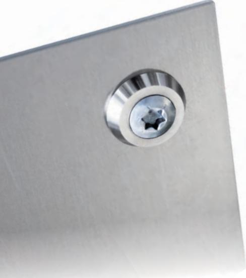
**IT** rosetta in acciaio massiccio. montaggio diretto a parete, per ogni tipo di materiale di qualsiasi spessore; fissaggio: sistema a vite, montaggio frontale, uso universale. materiale: acciaio inox AISI304, vite torx in acciaio inox.
