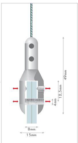
**IT** morsetto variabile in acciaio per pannelli con cavi. morsetto per cavi di acciaio o di nylon o per catenelle. il fissaggio del pannello e del cavo avviene tramite le brugole. materiale: ottone con cromatura. spessore del cavo: max. Ø1,8mm.
