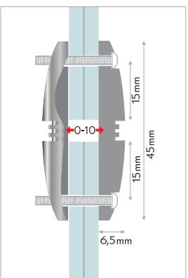
**IT** connettore variabile in acciaio per pannelli. morsetto in acciaio inox per la connessione verticale di pannelli. il fissaggio avviene tramite le brugole. fissaggio: connettore variabile per pannelli con diversi spessori. materiale: acciaio inox AISI303.
